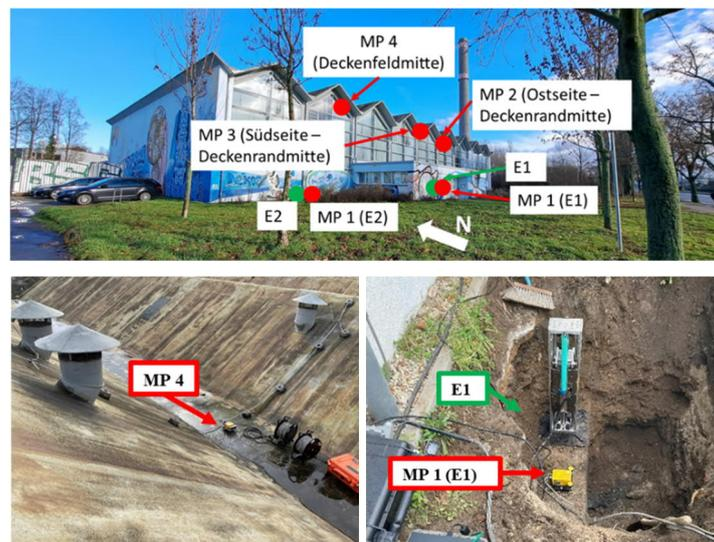
**Abbildung 9:** Übersicht der Messpunkte (oben), Messpunkt in Dachmitte (links), Erregerort (rechts)
