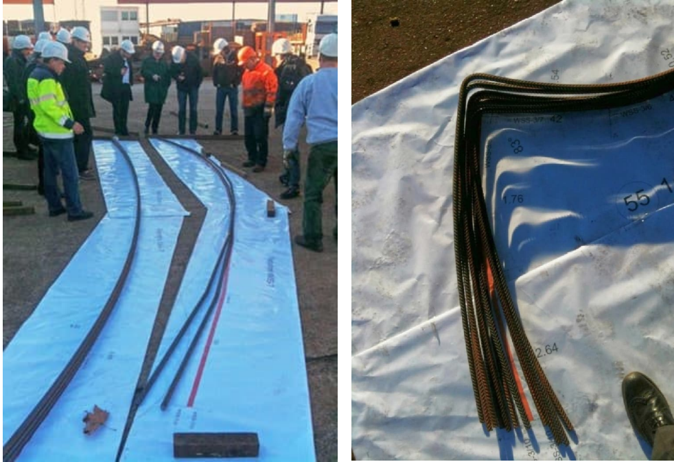
Abbildung 2 und 3: Biegeversuche in den Jahren 2014/2015 zur Ermittlung der Maßhaltigkeit, Formtreue und Reproduzierbarkeit
