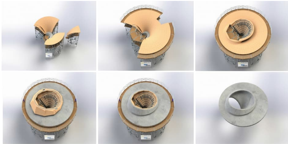
Abbildung 8: Der komplexe Ein- und Ausschalprozess
