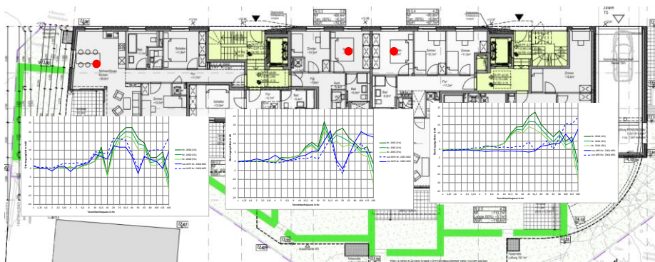
Abbildung 5: Projekt A Erdgeschoss: Vergleich Übertragungsfunktionen Fundament – Deckenfelder Messung (blau) / Berechnung (rot)
