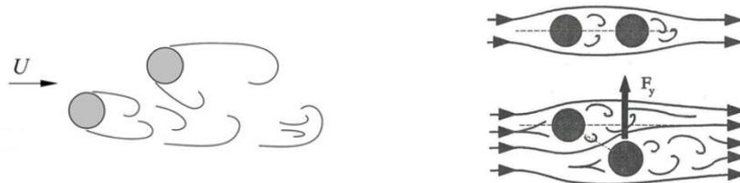
Abbildung 2: Wirbelablösung [7] (links) und Gap-flow [3] (rechts) für Zylinder in Gruppenanordnung
