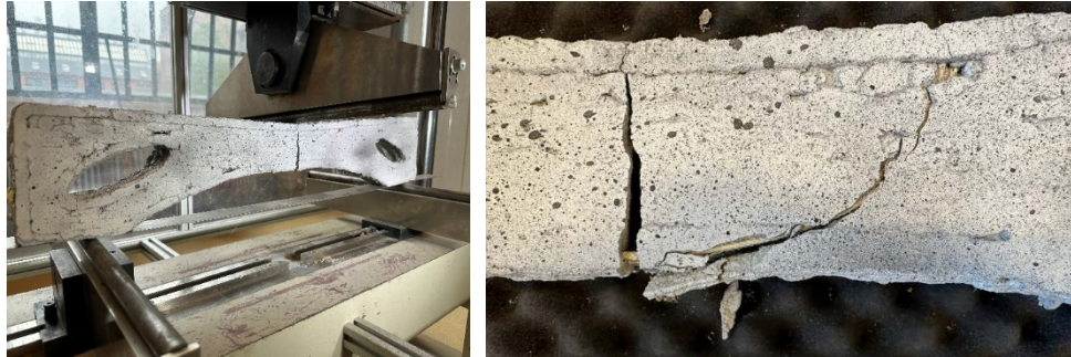
Abbildung 6. Dreipunkt-Biegeversuch an der Laborbrücke (links) und Rissbild im Versagenszustand (rechts)
