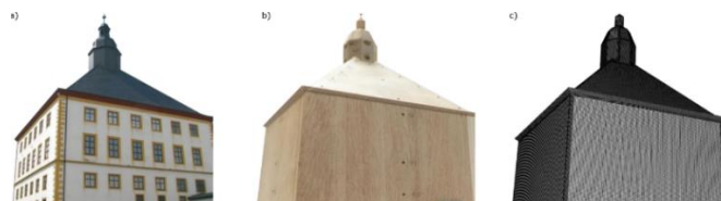
Abbildung 2: Links: Fotos des West-Turmes, Mitte: Windkanalmodell, Rechts: numerisches Gitter
