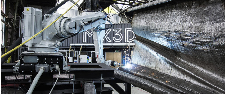
Abbildung 7: Fertigung eines Brückenelements mittels DED mit einer Anlage von MX3D [12].
