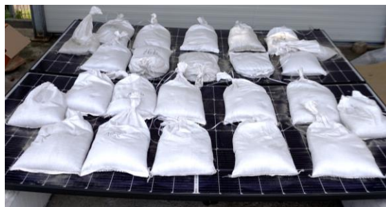
Abbildung 4: Resttragfähigkeitsversuch an einem PV-Modul
