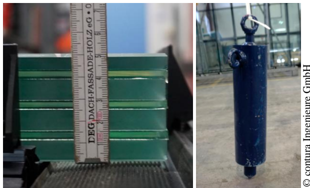
Abbildung 3: Beispielhaftes Glastpaket aus 4-fach VSG (links) und Stoßkörper (rechts)
